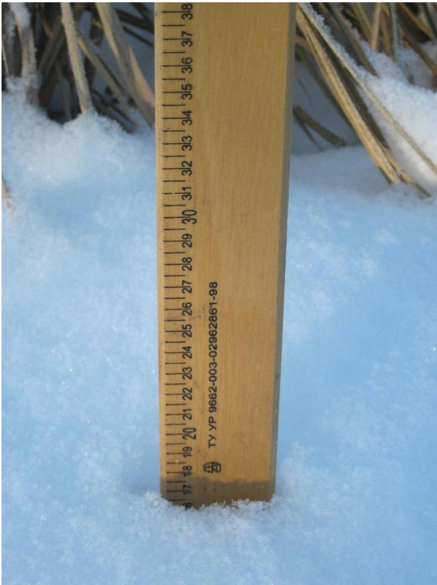
Рисунок 15 – Измерение высоты снежного покрова (11.12.2013г.)
